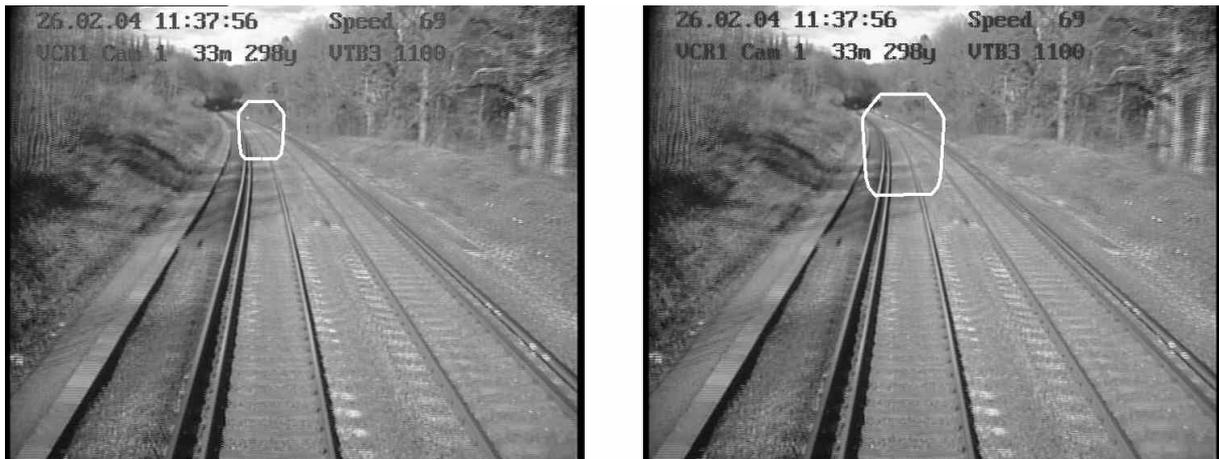
Abbildung 4.30: Eingezeichnetes Lichtraumprofil in 2 Entfernungen
